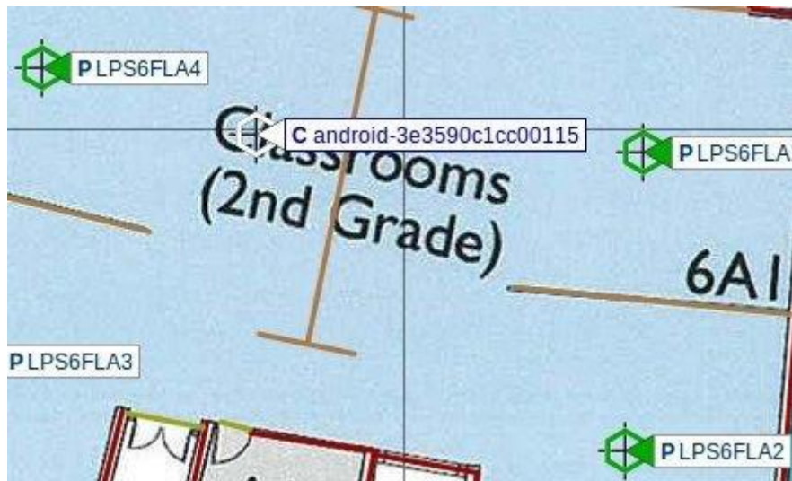
Figuur 9, posities van clients op een plattegrond van de Aerohive HiveManager
